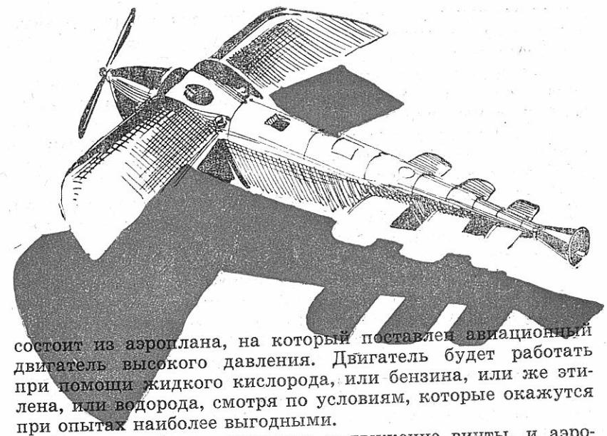
состоит из аэроплана, на который поставлен авиационный двигатель высокого давления. Двигатель будет работать при помощи жидкого кислорода, или бензина, или же этилена, или водорода, смотря по условиям, которые окажутся при опытах наиболее выгодными.
